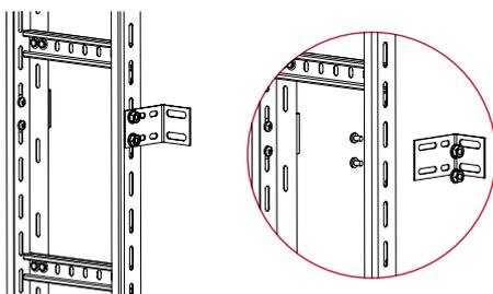
**!** Скоба СКЛ предназначена для фиксации лотков серий ЛНМЗТ, ЛПМЗТ, УЛН, УЛП, НЛО за боковые стенки. Рекомендуем использовать винты М6х12 (М6х16) и гайки М6 с буртиком.
