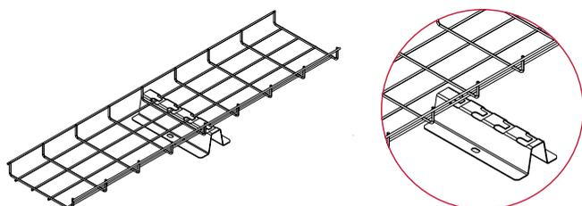
**!** Держатель ННД предназначен для фиксации проволочного лотка ПЛМ. Предусмотрено безвинтовое крепление лотка путем сгибания фиксирующих лепестков кронштейна шлицевой отверткой.
