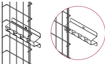
**!** Держатель ННД предназначен для фиксации проволочного лотка ПЛМ. Предусмотрено безвинтовое крепление лотка путем сгибания фиксирующих лепестков кронштейна шлицевой отверткой.
