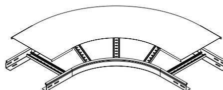
**!** Крышка КПЛНЛО90 предназначена для защиты кабеля от воздействия атмосферных осадков, пыли, падения посторонних предметов и касания человека. Поворот имеет замок круглой формы, крышка прижимается к повороту до характерного щелчка, не требует дополнительных элементов фиксации. В местах с повышенными ветровыми нагрузками рекомендуем использовать универсальные хомуты серии ХКП.
