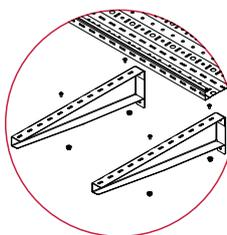
**!** Рекомендуем фиксировать лотки серий УЛН, УЛП, ЛНМЗТ, ЛПМЗТ, НЛО винтами М6х10 (М6х12) и гайками М6 с буртиком. Проволочный лоток ПЛМ комплектом СПЛО-20. Лотки шириной 100, 200 мм – одним комплектом, лотки шириной 300, 400 мм – двумя комплектами крепежа.
