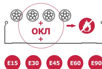
Испытания на огнестойкость систем ОКЛ должны проходить в соответствии с ГОСТ Р 53316-2021 «Электропроводки. Сохранение работоспособности в условиях стандартного температурного режима пожара. Методы испытаний». В результате испытаний каждой линии присваивается свой предел огнестойкости (E).
