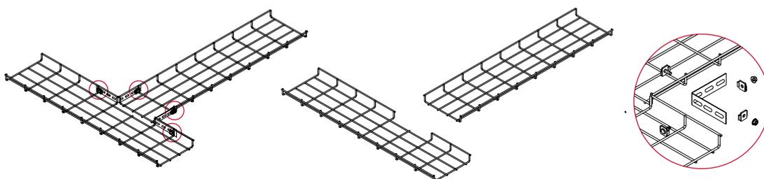
**!** Для организации отвода удалите фрагменты прутка проволоки, как показано на рисунке. Установите два соединителя проволочного лотка СПЛП на один лоток, согните под углом 90 градусов. Зафиксируйте второй лоток, используйте соединители СПЛД-20. Допускается использование СПЛО-20.
