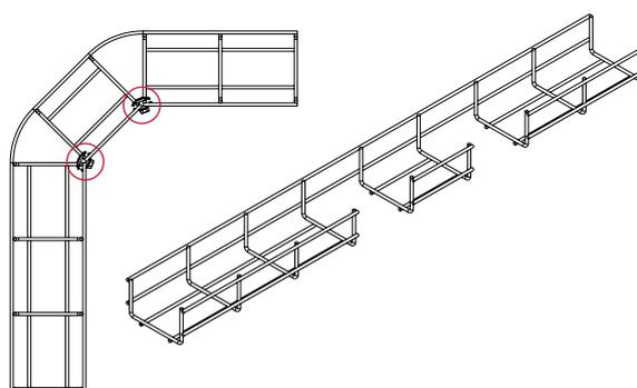
**!** Для организации плоского угла удалите фрагменты прутка проволоки, как показано на рисунке. Для фиксации угла используйте соединители СПЛД-20.
