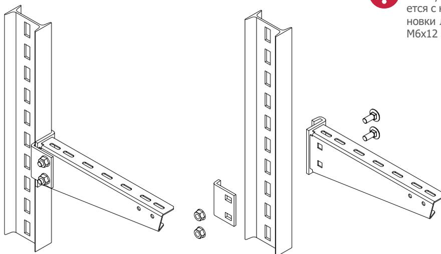
**!** Консоль подвеса КПС81 устанавливается на стойку подвеса СПТ8. Консоль КПС81 поставляется с комплектом крепежа. Для надежной установки лотков рекомендуем использовать винты М6х12 и гайки М6 с буртиком.
