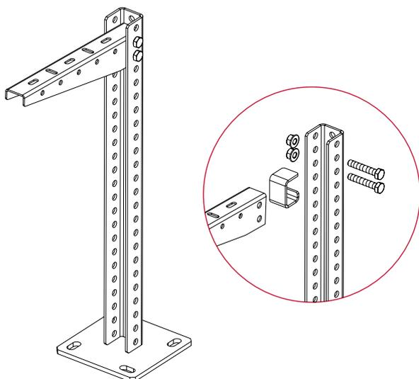
**!** Стойка потолочного подвеса СПСУ предназначена для размещения консолей КПН1 на горизонтальных поверхностях. Имеет увеличенную опорную пластину. Для фиксации консолей КПН1 к СПСУ рекомендуем использовать болты М8х45 и гайки М8 с буртиком.
