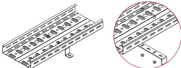
**!** Скоба предназначена для фиксации лотков всех серий, кроме НЛО. Для крепления лотков рекомендуем использовать винты М6х12 и гайки М6 с буртиком.
