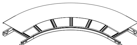
**!** Крышка КПЛНЛО90 R600 предназначена для защиты кабеля от воздействия атмосферных осадков, пыли, падения посторонних предметов и касания человека. Поворот имеет замок круглой формы, крышка прижимается к повороту до характерного щелчка, не требует дополнительных элементов фиксации. В местах с повышенными ветровыми нагрузками рекомендуем использовать универсальные хомуты серии ХКП.
