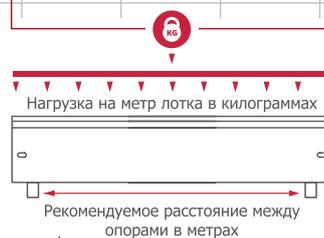
На страницах каталога размещены графики, отражающие зависимость допустимых нагрузок на лоток от шага опор. Расстояние между опорами указано в метрах (м), допустимая нагрузка в килограммах на метр (кг/м). При соблюдении рекомендованного на графике шага опор соблюдаются требования ГОСТ Р 52868-2021 в части Безопасной Рабочей Нагрузки.
