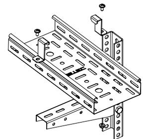
**!** Прижим для крепления лотка (без крышки) ПКЛ предназначен для фиксации кабельных лотков и кабельных лестниц на опорных конструкциях.
