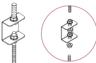
**!** Кронштейн КППЛС предназначен для организации подвеса на шпильках различного диаметра – М6, М8, М10. Для фиксации рекомендуем использовать пару гаек М8, М10 с буртиком. При фиксации шпильки М6 необходимо предусмотреть дополнительные широкие шайбы.
