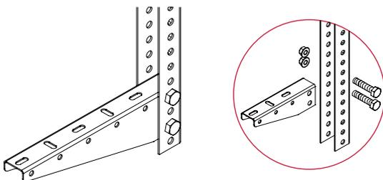
**!** Консоль КПН1 предназначена для размещения лотков серии ЛНМЗТ, ЛПМЗТ, УЛН, УЛП с нагрузкой от 10 до 150 килограммов. Консоли устанавливаются в планки НПП-120 и стойки СПТ1. Для фиксации консолей рекомендуем использовать болты М8х45 и гайки М8 с буртиком.
