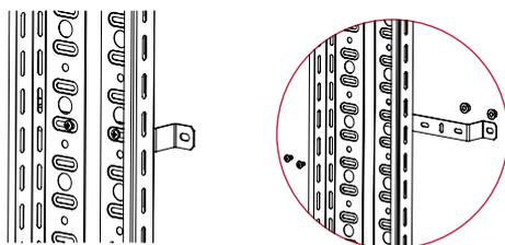
**!** Скоба для настенного монтажа СН предназначена для фиксации лотков всех серий, кроме НЛО. Для крепления лотков рекомендуем использовать винты М6х12 и гайки М6 с буртиком.
