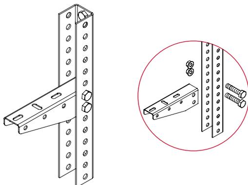
**!** Стойка потолочного подвеса СПТ1 предназначена для крепления консолей серии КПН1. Для фиксации консолей рекомендуем использовать болты М8х45 и гайки М8 с буртиком.
