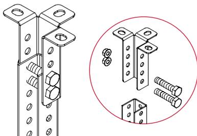
**!** Кронштейн потолочный УКП предназначен для фиксации стоек СПТ1. Для фиксации стоек рекомендуем использовать болты М8х45 и гайки М8 с буртиком.
