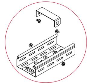
**!** Скоба СВ фиксирует кабель при вертикальной прокладке трассы, предотвращает касание кабеля и крышки лотка. СВ используется как дополнительное ребро жесткости при прокладке трассы на неровных поверхностях. Рекомендуем размещать СВ через каждые 500 мм. Скоба устанавливается внутрь лотка, фиксируется винтами М6х12 и гайками М6 с буртиком.
