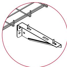
**!** Кронштейн КНПЛБ предназначен для размещения проволочного лотка ПЛМ. Предусмотрено безвинтовое крепление лотка путем сгибания фиксирующих лепестков кронштейна шлицевой отверткой. Возможно дополнительное крепление комплектом СПЛО-20.
